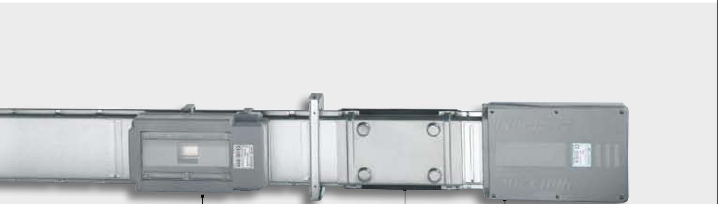
Отводные блоки с зажимами для подсоединения кабелей сечением до 25 мм<sup>2</sup>. Корпус из самозатухающей ударопрочной пластмассы с высокими изоляционными качествами. Втычные блоки могут устанавливаться или извлекаться когда шинопровод находится под напряжением.
